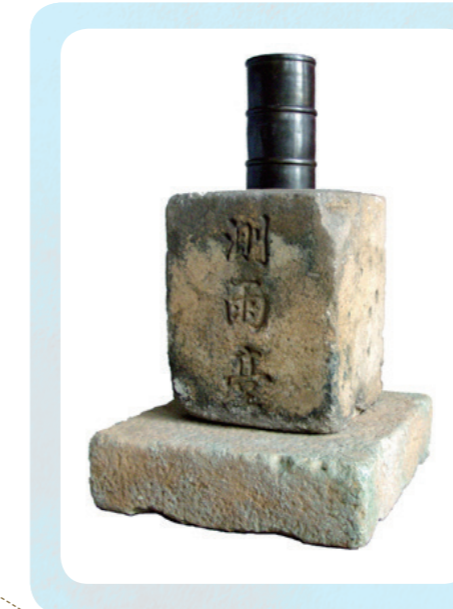
조선 시대의 측우기(기상청) 1440년을 전후하여 발명되어 1442년(세종 24)부터 20세기 초까지 조선 왕조의 공식적인 우량 관측 기구로 사용된 도구로, 현대의 우량계에 해당한다. 금속제 원통형 그릇에 빗물을 받아 표준화된 눈금의 자로 그 깊이를 측정했으며, 같은 규격의 기구와 자를 서울의 천문 관서와 지방의 관아에 설치하여 전국적으로 우량 관측 및 보고 체계를 갖추었다.
